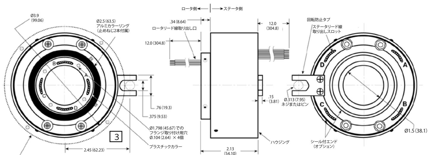
オプションフランジ外径127、取り付け穴4個  $\varnothing 5.461$  が  $\varnothing 114.3$  の直径上に等間隔で配置されていて、フランジ取付用プラスチックカラー上でスリップ回転するタイプのもの。フランジの厚さは6.35。
