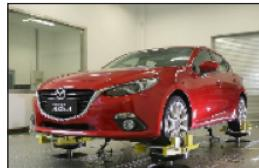
4姿勢テストシステムには、低摩擦、高速、高側荷重耐力用の静圧軸受試験アクチュエータがあります。我々のシステムは、乗り心地評価および騒音・振動・ハーシュネス(NVH)試験に使用される研究所で採用されています。それらは、選択されたボディ、シャーシ、およびサスペンションの設計を検証するために、耐久性試験ラボで使用される。それらはまた、しゃがみおよびガタガタの懸念を評価するために生産設備においても使用されます。
