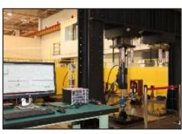
油圧試験システムは、多くの試験物品に対する高サイクル構造耐久疲労試験の基礎である。ムーグは、長年にわたって信頼できる使用のために構築されたテストアクチュエータ、コントローラ、およびソフトウェアのような必要なビルディングブロックを提供する。おそらく、お客様は、当社のサーボバルブ製品をお客さまの試験装置に数十年間使用していました。
