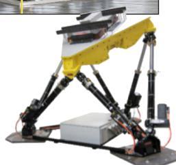
油圧シミュレーションテーブルは、加速度または変位入力を提供し、証明地上で収集された時間履歴データを再現する。試験サンプルは、一般に、EV電池、エンジン取り付けシステム、冷却モジュールまたはコックピットのようなボディー取り付け部品またはシステムを含む。小さなスクワット・プラットフォーム・フットプリントを有する人間定格電気シミュレーション・テーブルは、6自由度運動を提供するために電気アクチュエータを組み込んでいる。テストコントローラは、快適性評価のための正確な制御を提供するために、振動スペクトルまたは時間履歴を再生する。
