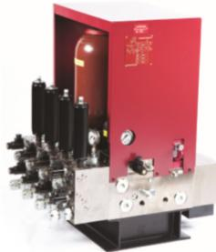
Moog Hydraulic Service Manifold(HSM)は、オフから高圧への調整可能な遷移を伴うオン/オフ油圧を提供する。フィルタは、敏感なサーボ弁およびアクチュエータを保護して、必要なときに瞬間的な流れまたは圧力減衰を提供する。1~4台のステーション・オプションを備えたいくつかのフロー・レーティング・サイズが利用可能です。
